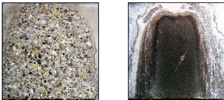
Rys 4. Widok próbek betonu po cyklu badań na odporność kwasową. Z lewej – beton kontrolny, z prawej beton SWB
